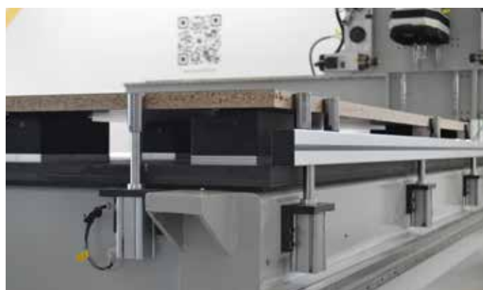
Topes de referencia y ventosas. Detalle composición en mesa Nesting.
