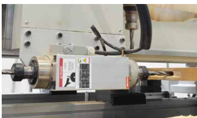
Motor horizontal doble salida Mecanizado de cerraduras
