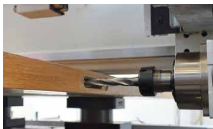
Motor horizontal doble salida Mecanizado de pernios
