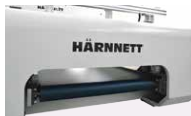
Banda de descarga de residuos
