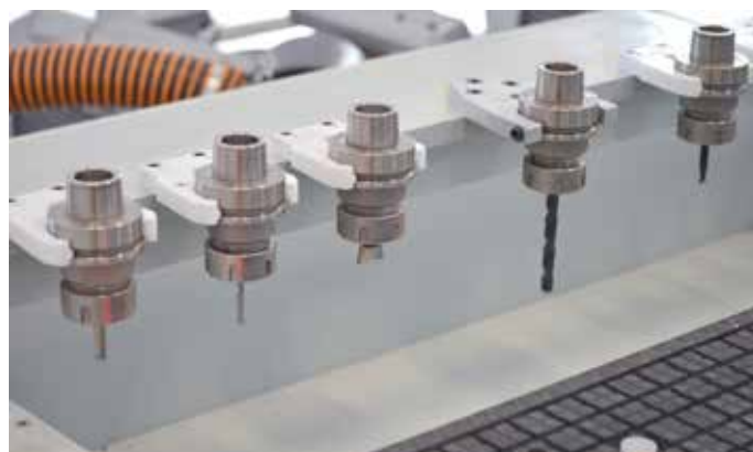
Cambio de herramienta lineal HSK-F63
