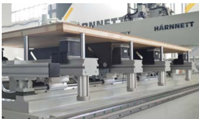
Topes de referencia y ventosas. Detalle composición en mesa de consolas
