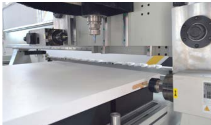
Detalle grupo de trabajo, cambio lineal, ventosas. Mecanizado de pernio
