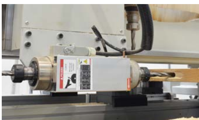
Motor horizontal doble salida Mecanizado de cerraduras
