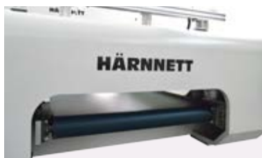
Banda de descarga de residuos
