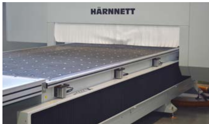
Fuelles y guías lineales especiales para materiales abrasivos
