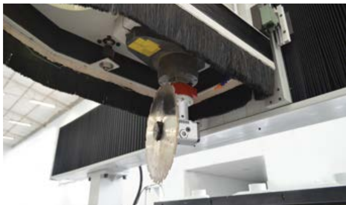
Detalle grupo fresador con eje C HSD 360° y disco
