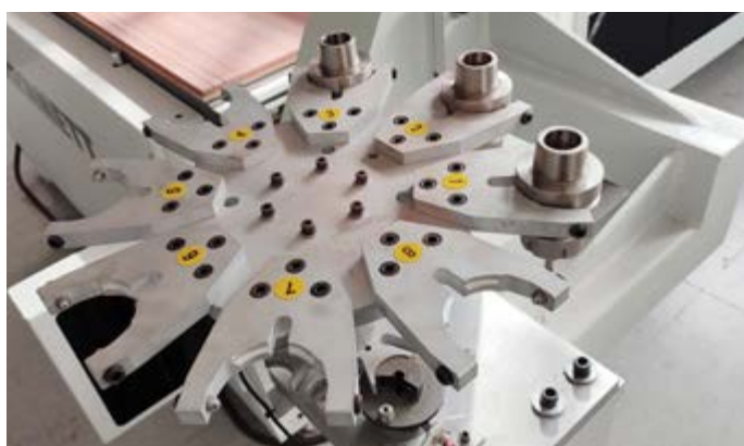
Cambio de herramienta revólver a bordo 8 posiciones con enganche HSK-F63
