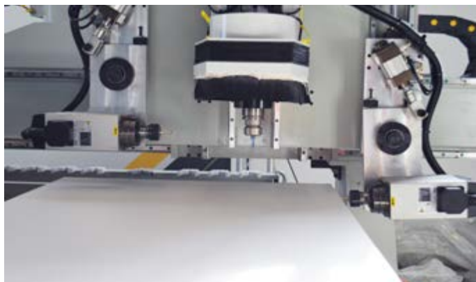
Motores horizontales inclinables especial mecanizado lambor
