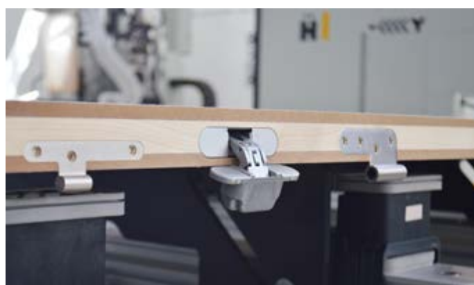
Mecanizado de distintos tipos de pernio en puerta con lambor
